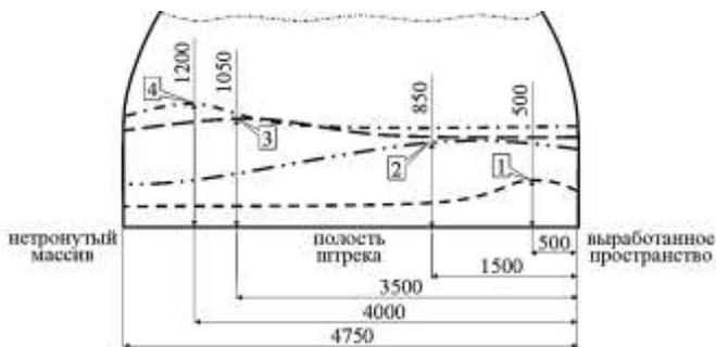
1 – при бетонной ПП; 2 – при НК из шпального бруса; 3 – при НК из кругляка  $\varnothing 250$  мм; 4 – при НК из кругляка  $\varnothing 150$  мм
